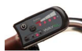
Centralina di controllo multifunzione: funzione soft start, 3 livelli di assistenza
